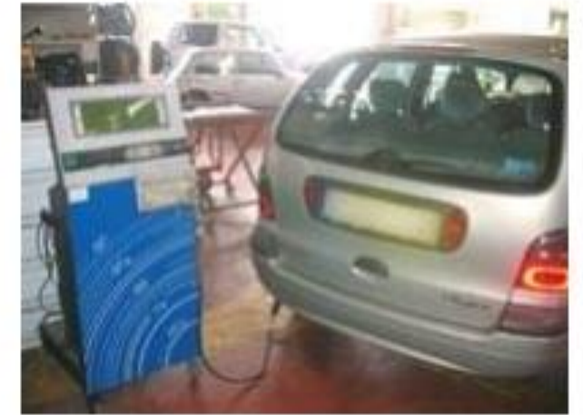
Mesure directe des gaz polluants sur une station d'essai automatique
